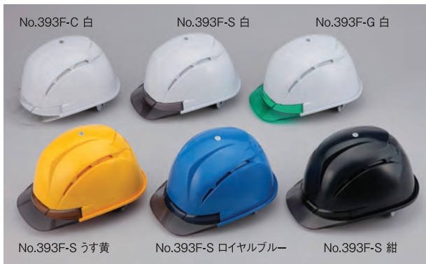
帽体：ABS ひさし：ポリカーボネート ●ひさし長さ：約33mm ●サイズ：53～62cm
